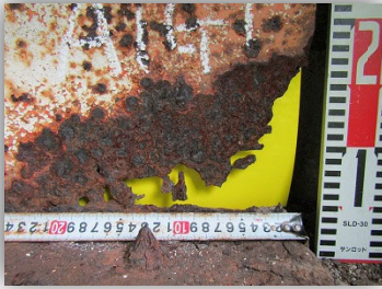
腐食 主桁の腐食が進行し穴が空いている状態
